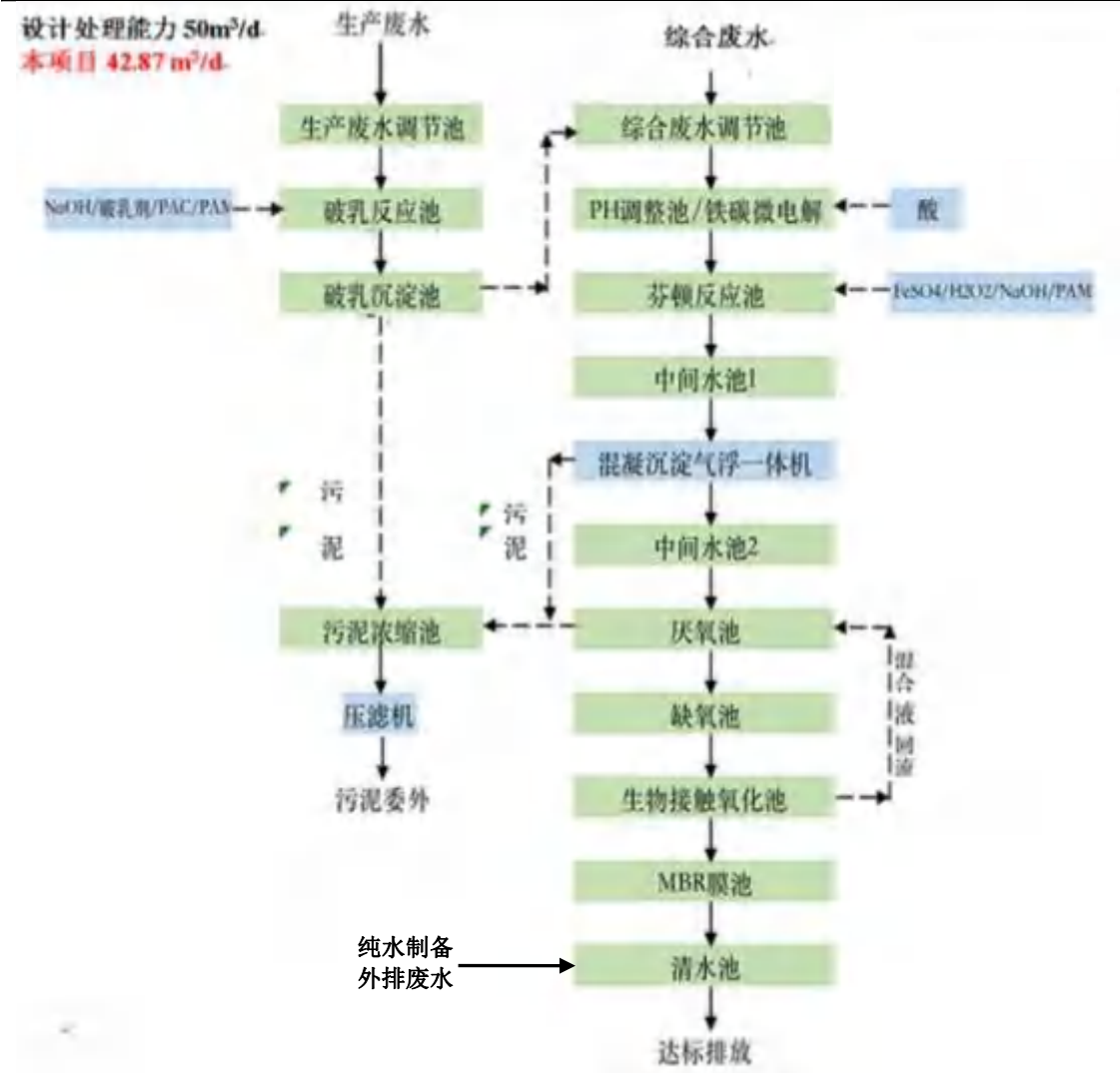
图 4-1 项目废水处理工艺流程图
